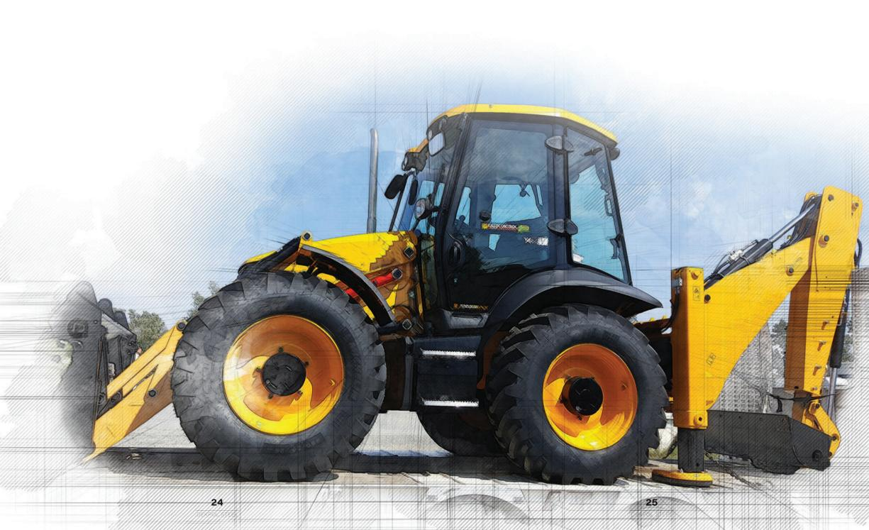
Beschreibung: Standardlöffel mit geschraubten Zähnen, Direktanbau; Verschleißstreifen; Messer HB500; Seitenschneiden HB400
